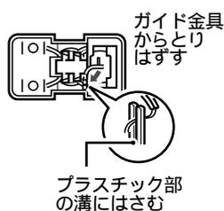
3 同軸ケーブルを差し込み、先端をガイド金具に巻き付ける
