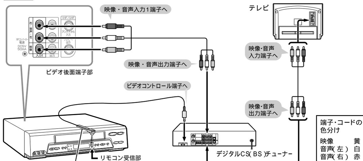
ビデオコントローラー(ビデオマウス)対応のデジタルCS(BS)チューナーの場合、チューナーの取扱説明書に従って、ビデオのリモコン受信部の前方に取り付けます。
