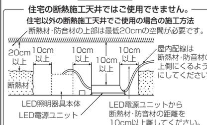
LED電源ユニット本体表示または本説明書に従って施工してください。施工に不備があると、火災・感電・落下の原因となります。
