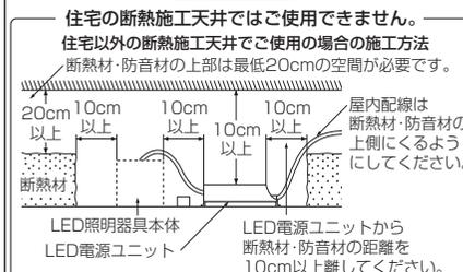
LED電源ユニット本体表示または本説明書に従って施工してください。施工に不備があると、火災・感電・落下の原因となります。
