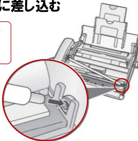
**5** 原稿送りローラーの左端を戻し、**[解除レバー]** を後ろに戻す
