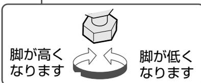
給水・排水ホースから水漏れなどの異常がないか、水平に設置されているか確認してください。
