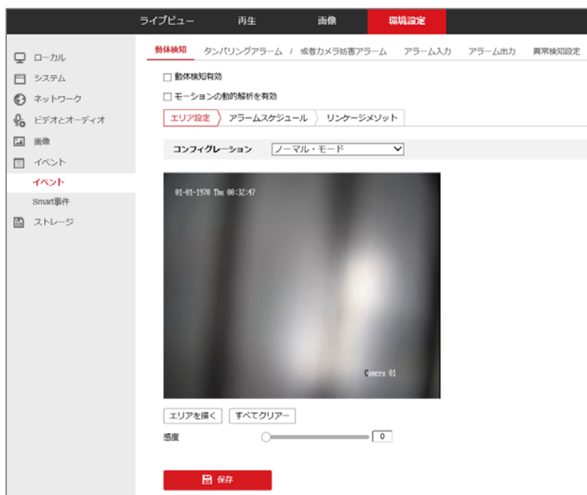
図 9-1 動体検知の有効化
