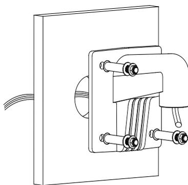
2. カメラ取付キャップを壁面取付金具のねじ切り部に接続し、カメラ取付キャップに付属の短ネジ3本を取付けます。カメラ取付キャップを取付部近くの穴から止めネジ2本で固定します。
