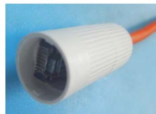
ネットワークケーブル⑦をロックナット⑥、防水ラバーガスケット⑤ (ラバーガスケットのはめ込み突起が防水エンドキャップ側を向いていること)、防水エンドキャップ④の順に通し、ネットワークプラグ (RJ45) ③をネットワークケーブル⑦の端に取り付けます。PTZ カメラのネットワークインターフェイスソケット①の端に O 型ガスケット②を取り付け、ネットワークプラグ③をカメラのインターフェイスソケット①に挿入します。防水ラバーガスケット⑤を防水エンドキャップ④に挿入し、ロックナット⑥を防水エンドキャップ④に取り付けます。エンドキャップ④の留め金をカメラのネットワークインターフェイスソケット①の切込みに合わせ、防水エンドキャップ④をカメラのネットワークインターフェイスソケット①に固定します。
