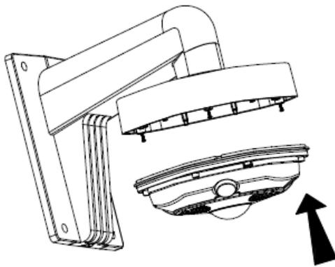
5. カメラ本体へカメラカバーをかぶせて、ねじで固定します。
