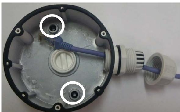
6. 対象機種ドームカメラにあるビスを緩めて、球形カバーとカメラ本体の 2 つに分解します。
