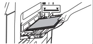
トレイ2~4で8-1/2" x 11"サイズ以上の用紙をセットする場合は、トレイの手前と奥にある2つの緑色の規制板を取り外してからセットしてください。取り外した規制板はトレイ内部の奥側の収納スペースに保管してください。
