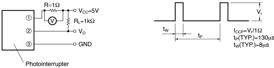
Fig.2 距離特性測定方法
