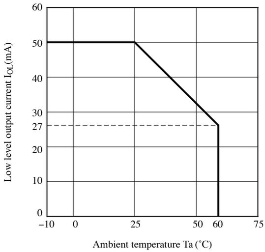
Fig.6 ローレベル出力電圧—周囲温度特性
