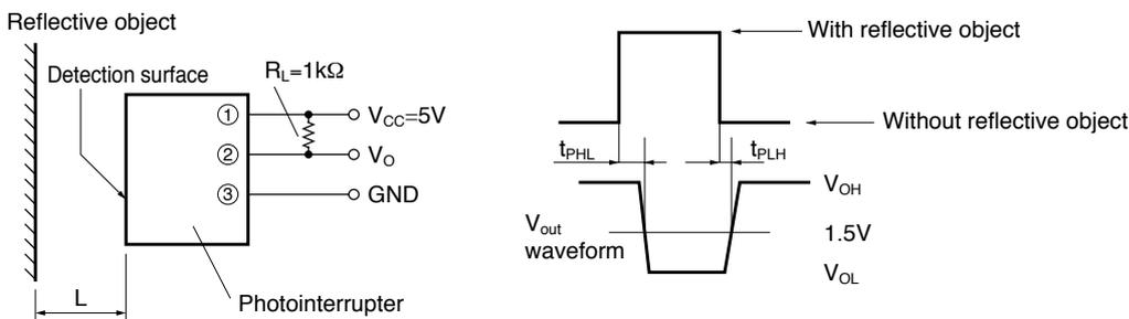
Fig.4 外乱光許容照度測定方法
