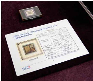
図B ノーマリ・オフ型の酸化物半導体TFTを使ったマイクロプロセッサの試作品
