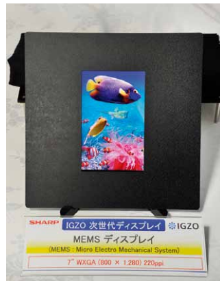
図3 米Pixtronix社と共同で開発しているMEMSディスプレイ
