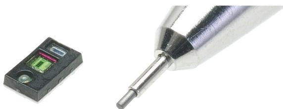
写真1 照度センサー一体型近接センサ
