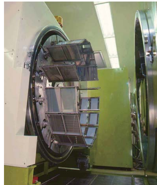
ガラスの基板に薄膜を高温で真空蒸着するELパネル蒸着装置
