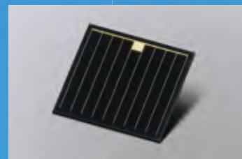
変換効率35.8%を実現した化合物3接合型太陽電池
