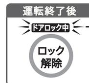
運転中はドアをロックし、「ドアロック中」ランプが点灯します。
