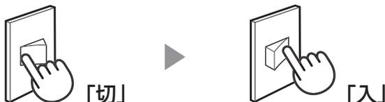
※運転中に壁スイッチで電源を切ると、ルーバーが開いた状態で運転停止します。
