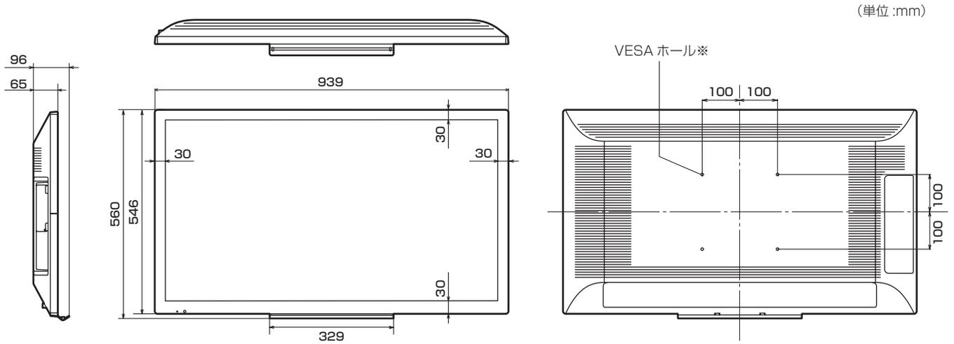
※ VESA 規格の金具の取り付けには、M6 ネジで、長さが取り付け金具の厚さ +8 ~ 10mm のものを使用してください。
