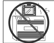
高圧機器の設置されている盤内での取り付けは避けてください。
