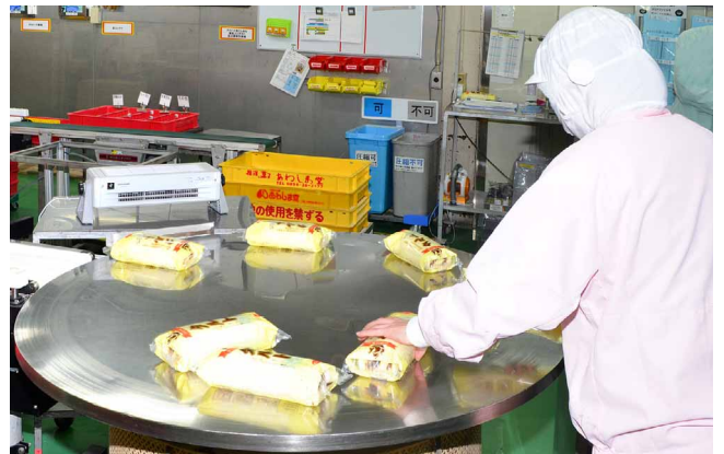
包装フィルムを除電することで、作業者が静電気を気にせず作業できる
