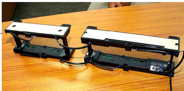
(株)帝国ホテルさまとの共同開発で商品化した「空調ダクト収納型プラズマクラスターイオン発生ユニットシステム」
