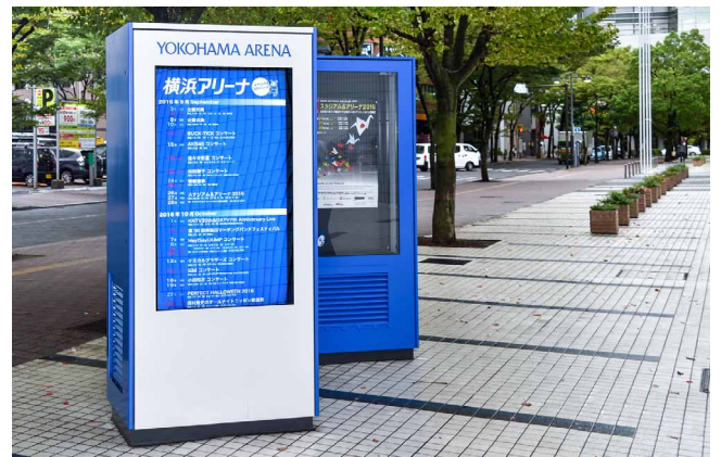
防水筐体に格納し、2台のディスプレイを背中合わせに設置
