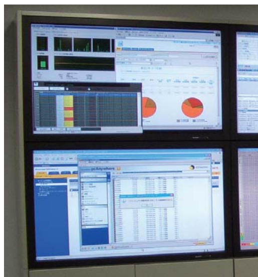
1画面に複数のウィンドウを表示できる。オペレーションディスクのパソコンディスプレイとはマルチモニターになっており、KVMスイッチを介して複数のクライアントの情報を切替えながら表示。
