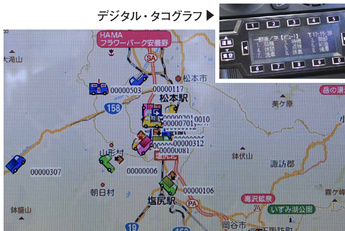
トラックに装備したデジタル・タコグラフとの連携で、走行状況・作業状況を常時一覧把握
