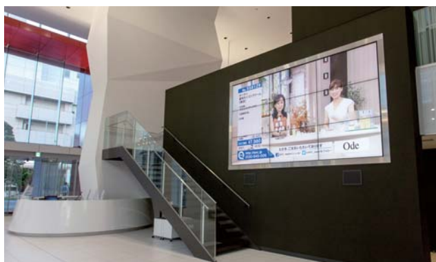
エントランス待合室に設置された60V型×9面マルチシステム
