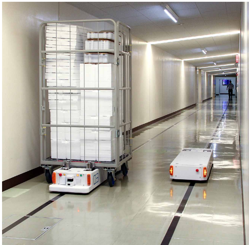
AGV : W400mm カゴ車 : W850mm×D650mm×H1700mm
