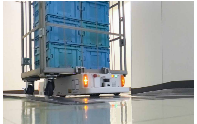
スロープ走行(傾斜2°)に対応し、坂の途中での緊急停車も可能
